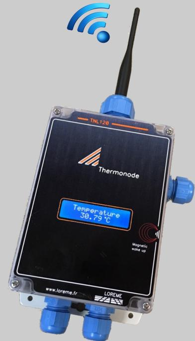
Le TNL120mA est une centrale d'acquisition, autonome et étanche, permettant de retransmettre par liaison radio un signal 4...20 mA, il peut former un reseau maillé de 32 émetteurs. Les mesures sont mise à disposition par protocole Modbus TCP sur le récepteur SML160mA.
